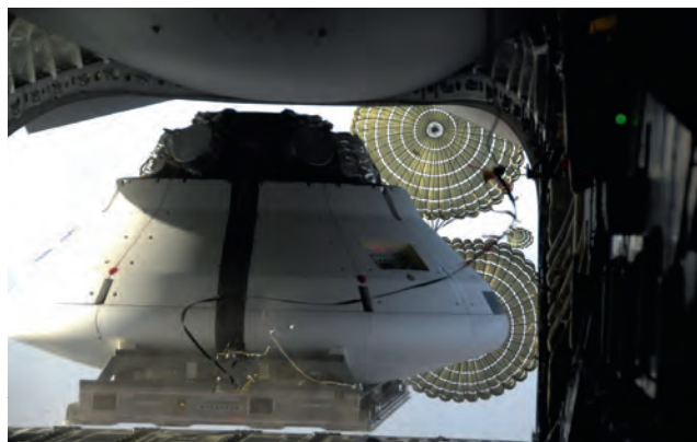
Egy Orion kabinmakett ejtőernyőrendszerének tesztelése
