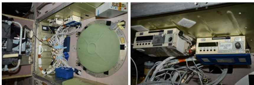
6. ábra: Két Pille kiolvasó (balra a régebbi és jobbra a 2018 júniusában felvitt új készülék) végez méréseket egymással párhuzamosan a Nemzetközi Űrállomás ugyanazon pontjában. A közeli felvételen az látszik, hogy az új kiolvasóval az egyik régebbi Pille dózismérő kiolvasása sikeresen megtörtént. A dózismérő még a kiolvasóban van, a kijelzőn pedig már látható is a Pille által mért dózis. (Fotók: RKK Enyergija/Roszkoszmosz)
