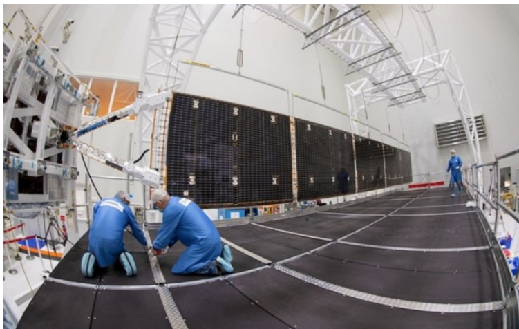
2. ábra: Az MTM egyik napelemtáblájának a szerelése. (Forrás: ESA)
