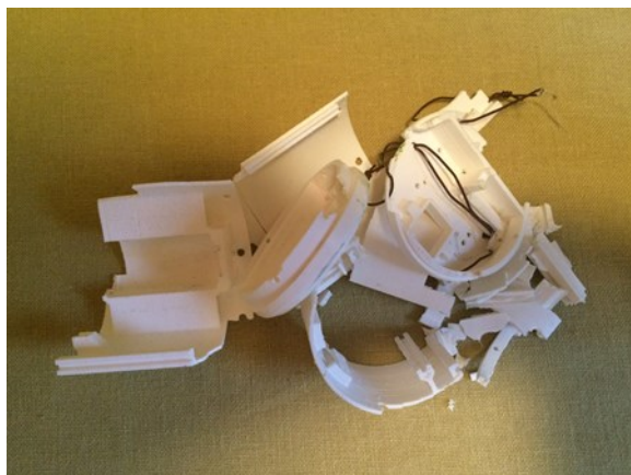
5. ábra: Nem minden drónos teszt sikerült elsőre jól... (ejtés 100 m magasból a Farkashegyi Repülőtéren)
