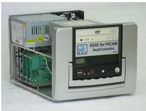
10. ábra: A PICAM bemérését szolgáló jelszintű szimulátor. (Forrás: SGF Kft.)
