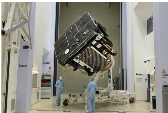
3. ábra: A Solar Orbiter a müncheni IABG tisztaszobájában 2019 őszén. Jól látszanak a távérzékelési műszerek apertúráinak nyílásai a hőpajzson, zárt állapotban. (Forrás: Airbus)
