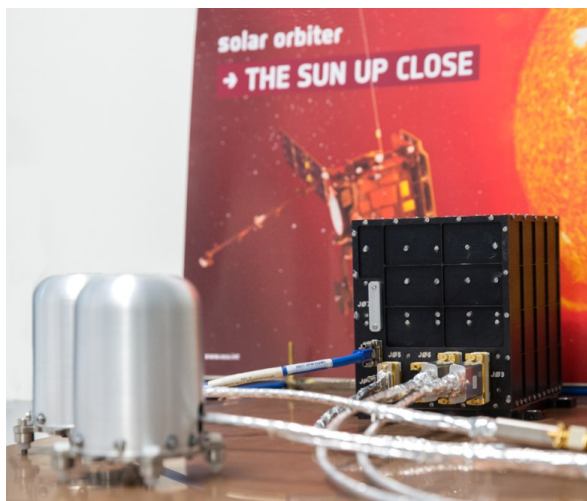
9. ábra: A Solar Orbiter magnetométer egységeinek fényképe. (Forrás: Imperial College)
