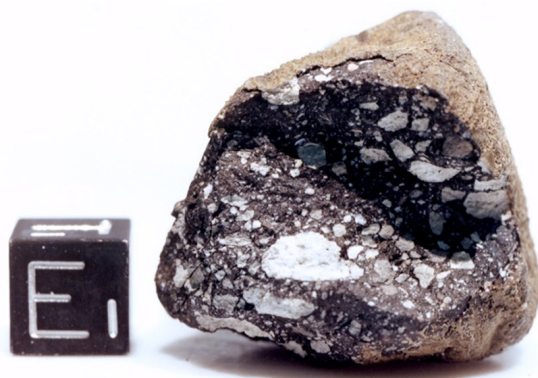
1. ábra: Az ALHA 81005 meteorit képe a tört felület irányából. Jól látható a zöldesbarna kéreg és a meteorit belsejét alkotó fekete alapanyag, benne a fehér és szürke klaszttal (a méretjelölő kocka éle 1 cm) [8]
