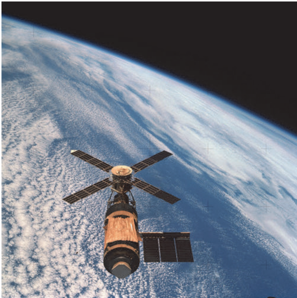
2. ábra: A Skylab űrállomás. Jól látszik a javítás utáni sérült rész fölé feszített aranyozott fólia, amely a hőpajzs szerepét töltötte be. (Forrás: NASA)
