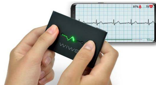
1. ábra: a WIWE készülék EKG mérés közben, okos telefonnal párosítva
