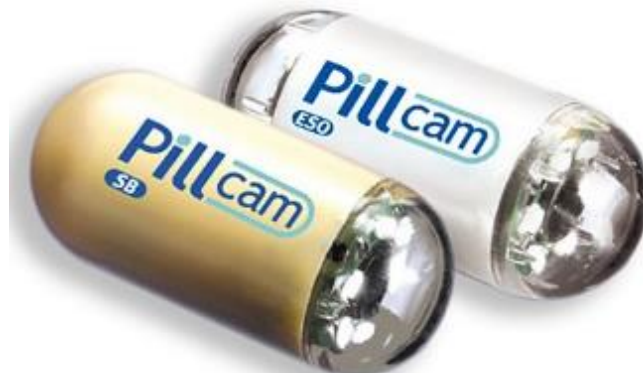
10. ábra: A Given Imaging által kifejlesztett M2A lenyelhető képalkotó kapszulái (Forrás: www.givenimaging.com )
