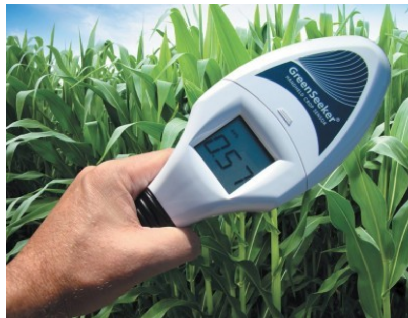
3. ábra: Kézi szenzoros mérés a vegetációs index meghatározásához (Forrás: https://nmisp.cals.cornell.edu )
