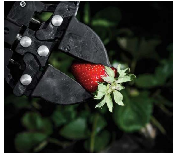
6. ábra: Eperszedő robot fogókarja (Forrás: https://www.newyorker.com )
