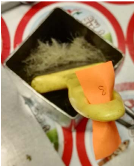
6. ábra Elhasználódott ecset a címketerelő kefék tisztításához
