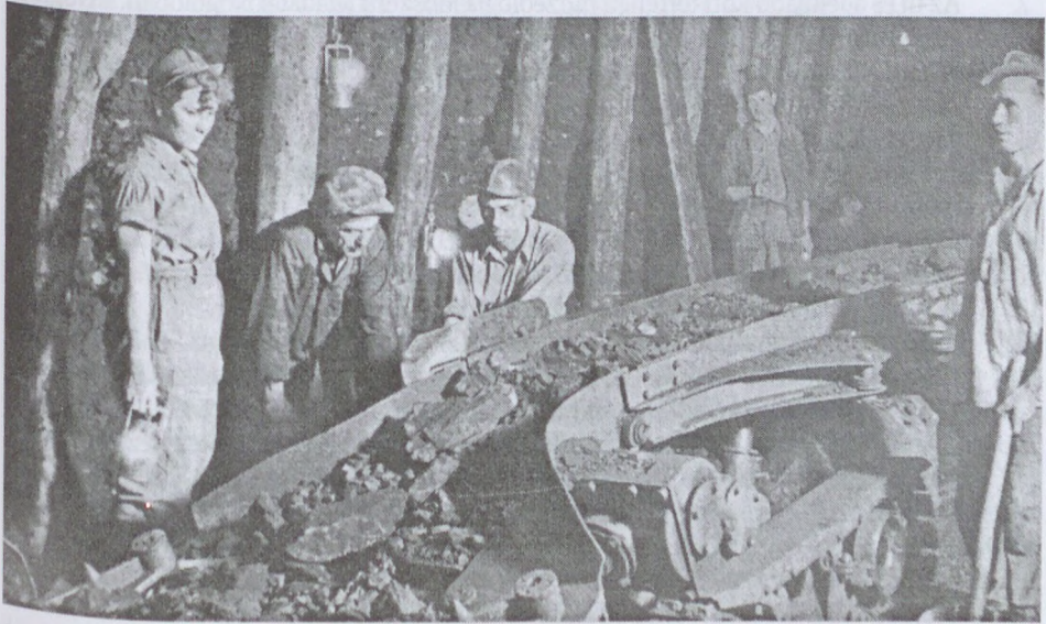
Az Sz-153-as típusú hernyótalpas alvázra szerelt terelőkaros, Szovjet gyártmányú önrakodó gép
