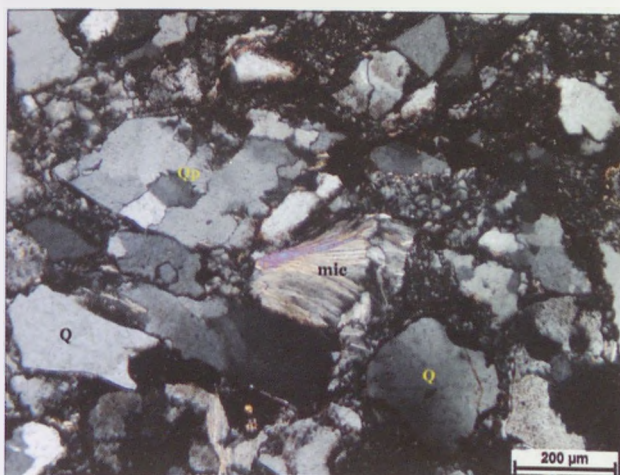
4. kép: Biotitból átalakult színtelen csillám és klorit (mic), monokvarc (Q) és polikvarc (Qp) (38/1, +N)
