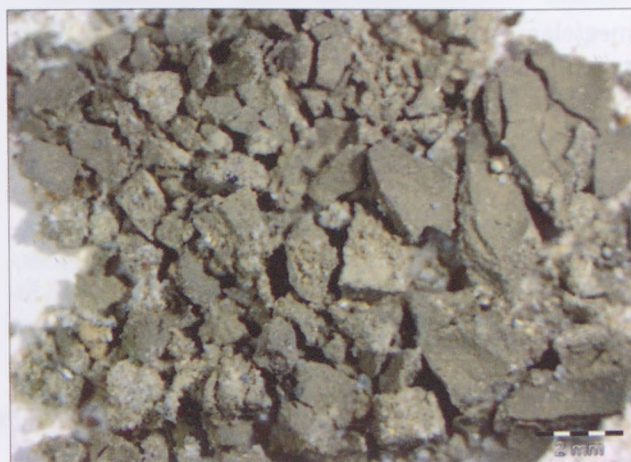
2. kép: A habarcsminta savazási maradékának mikroszkópos képe 12x-es nagyítással, amelyben csak nagyon finom szemcseméretű homok-agyag frakció maradt vissza
