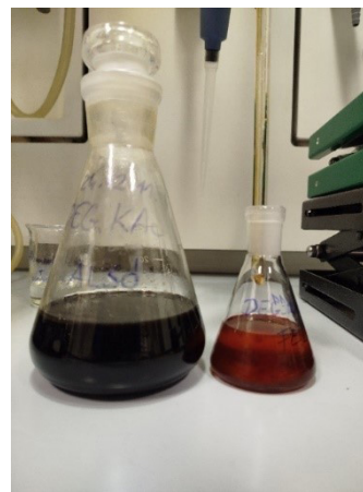
7. Ábra. Poliuretán habok glikolízissel történő bontásának termékei.
