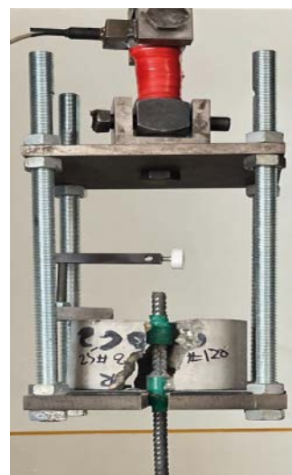
Fig. 10 Splitting failure of pullout cylinder specimen 10. ábra Hengeres próbatest hasadási tönkremenetele kihúzó vizsgálatnál
