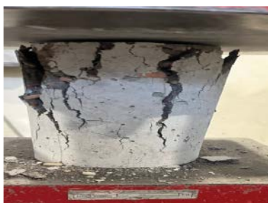
Fig. 6 Compression strength test 6. ábra Nyomószilárdság vizsgálat
