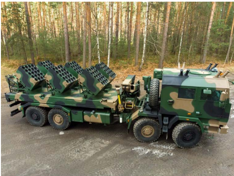
7. számú ábra. Lengyel BAOBAB-K műszaki aknaszóró rendszer 36
