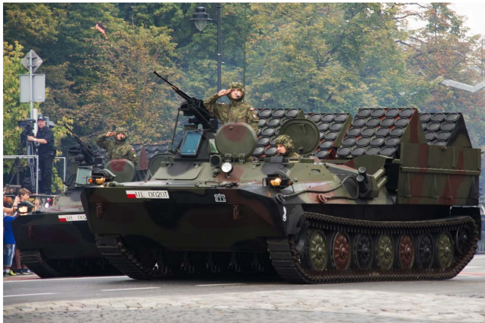
6. számú ábra. KROTON műszaki aknaszóró gép 32
