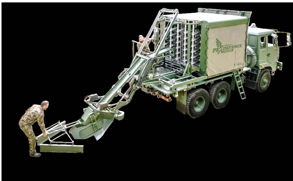
3. számú ábra: Lengyel ZUMP aknatelepítő műszaki jármű 21
