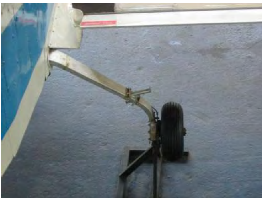
5. számú ábra. A GAK-22 fő futóművek laprugózású hőkezelt alumíniumötvözet hőkezelt-hengerelt kivitelben, elforduló laprugóbekötéssel
