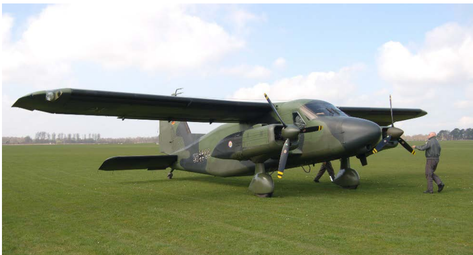
12. számú ábra. Dornier Do 28D kétmotoros többcélú könnyű repülőgép
