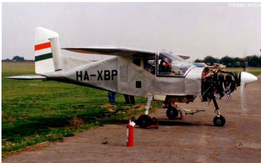
7. számú ábra. A GAK-22 Dino repülőgép alsó szárny és motorburkolat nélkül. Látható a Lycoming O-235 H2C négyhengeres, léghűtéses, benzinüzemű boxer elrendezésű repülőgépmotor
