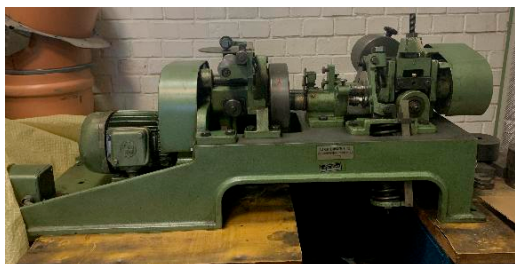
2. ábra. Amsler-féle duplatárcsás mérőműszer
