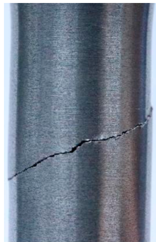
2. ábra. EN-GJS-500-14 próbatest tönkremenetele kombinált húzás-csavarás esetén [9].
