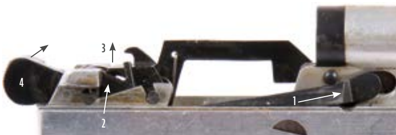
7. ÁBRA. Az M-9 pisztoly elsütőszerkezete elsütéskor (A szerző szerkesztése, Szikits Péter felvételének felhasználásával) [1]
