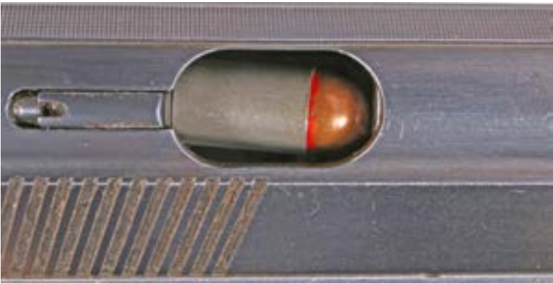
5. ÁBRA. A Makarov-töltény illeszkedése az M-9 kísérleti pisztoly peremágyába (Szikits Péter felvétele) [1]
