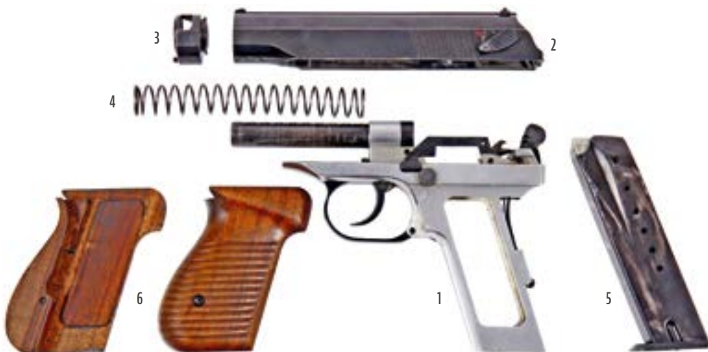
4. ÁBRA. Az M-9 pisztoly fő részei. 1. tok a csővel, a markolattal, az elsütőszerkezettel, a vezetőhornyokkal és a sátorvassal; 2. szán a célgömbbel, a nézőkével, az ütőszeggel, a biztosítóval, a vezetőlécekkal és a kivetőnyílással; 3. kompenzátor a bajonettzárval; 4. helyretoló rugó; 5. tölténytár az adogatótömbbel, az adogatórugóval, a tárfenékkal és rögzítőjével; 6. markolathéj (jobb, bal) (A szerző szerkesztése, Szikits Péter felvételének felhasználásával) [1]
