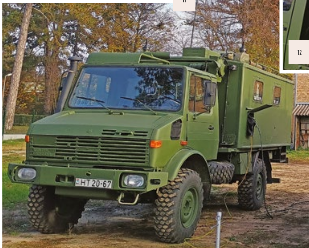
11. ÁBRA. Az R-142-M3 integrált rádióállomás és központ UNIMOG 435 járművön, DF-4 felépítménybe telepítve (A szerzők felvétele)
