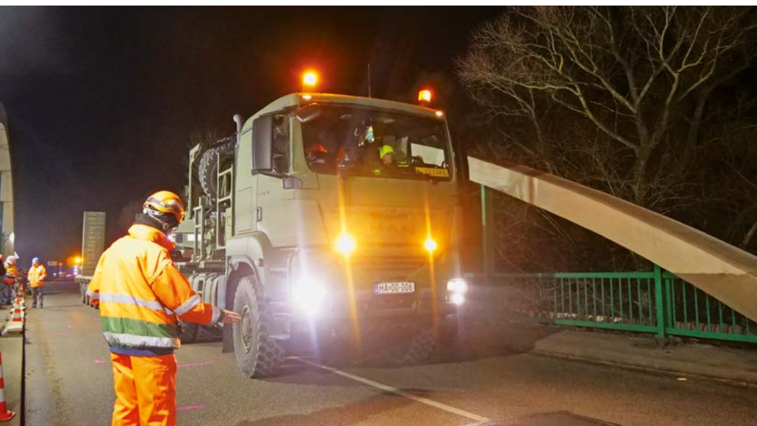
3. ÁBRA. Üres szállítótréler statikus terhelése hídtengelyben (Fotó: Kapin Benedek)
