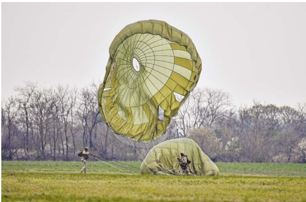
5. ÁBRA. OVP-12 SL-1, egy klasszikus körkúpolás deszant ejtőernyő (Fotó: Zrínyi Nkft. / honvedelem.hu / Rácz Tünde)
