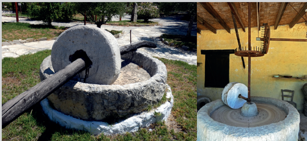
9. ábra. Olívabogyók zúzására használt, állati erővel (balra) és vízzel (jobbra) hajtott malomkövek (Oleastro Olive Park, Anogyra, Ciprus)
