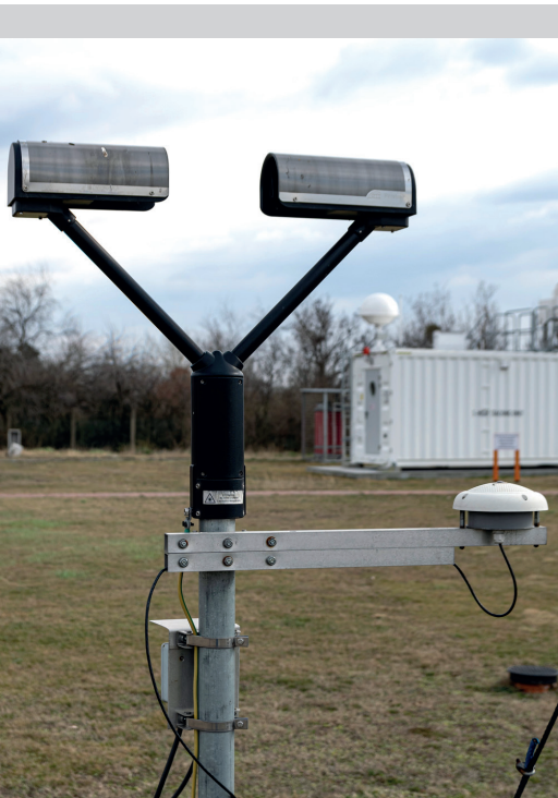
4. ábra. Cseppeloszlást mérő automata eszköz (fotó: Kálmán Imre)
