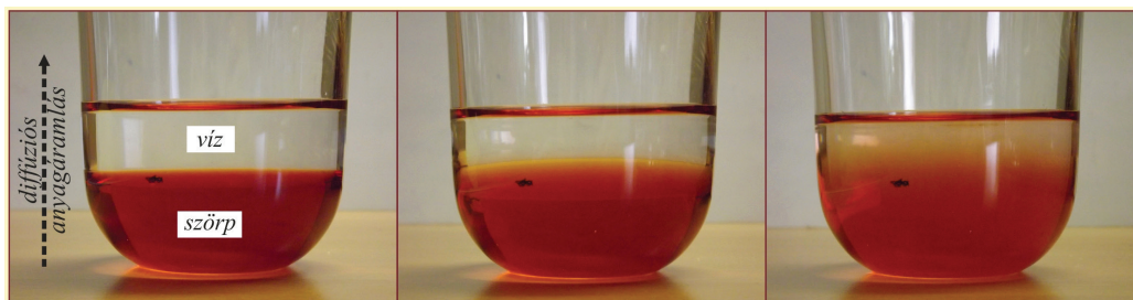
5. ábra. A diffúzió megfigyelése folyadékban: a tömény szörp és a felette elhelyezkedő víz közötti határfelület eleinte éles, majd fokozatosan elmosódóvá (diffúzzá) válik. A nagyobb sűrűségű (töményebb) oldatrész alul helyezkedik el, ezért a diffúzió viszonylag lassan játszódik le (középső kép: fél nap múlva, jobb oldali kép: 2 nap múlva).
