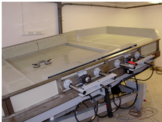
1. ábra. A modelltér feltöltés előtti állapotában, a villanymotorok és a dönthetőség a felső határon
