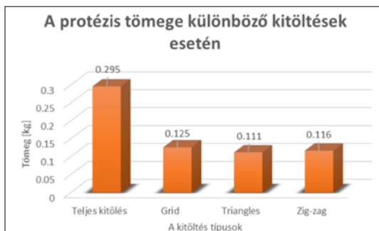
9. ábra. A protézis tömege különböző kitöltések esetén
