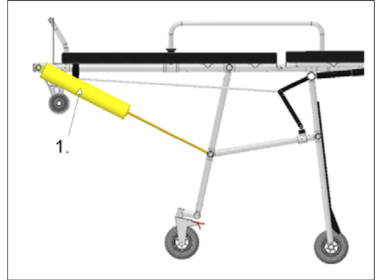
8. ábra. III. ajánlott megoldás nyitott állapotban: 1. munkahenger
