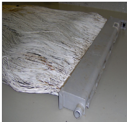
13. ábra. Membrántechnológia membránmoduleleme Karcagon [3]
