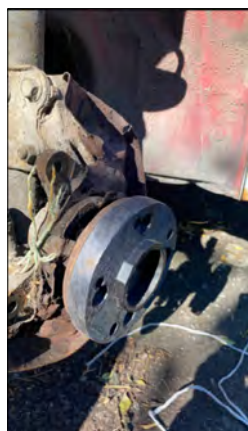
3. ábra. 3D-nyomtatott minta-osztókörmódosító
