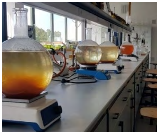
1. ábra. Koagulációs-flokkulációs kémiai kezelés
