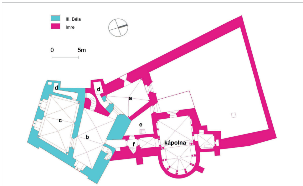
1. kép: Esztergom, a királyi vár déli épületei alaprajzának rekonstrukciós kísérlete, 1200 körüli állapot. (a: az északi épület tere, b: a lakótorony külső tere, c: a lakótorony belső tere, d: árnyékszékek, e: előcsarnok, f: összekötő tér) (Buzás 2010, 140., 25. kép nyomán)
