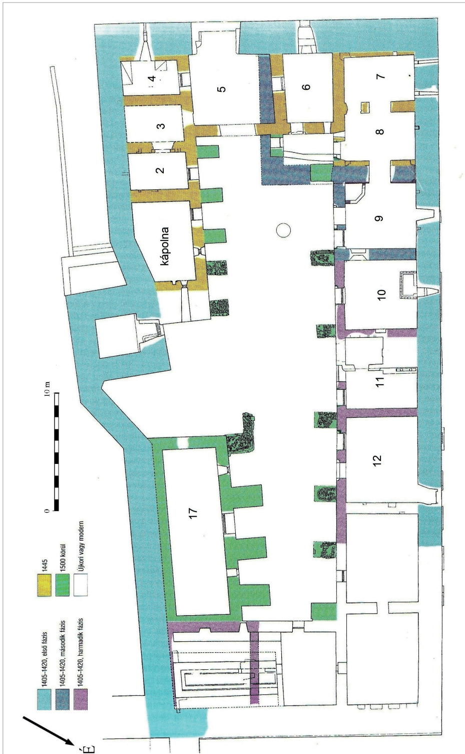
13. kép: A gyulai vár földszinti alaprajzi felmérése az építési periódusok feltüntetésével és a helyiségsszámozással (Feld 2000, 5. kép nyomán)
