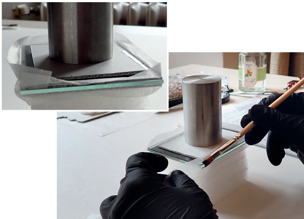
35–36. A két üveglap rögzítése japánpapírcsíkkal és keményítővel
