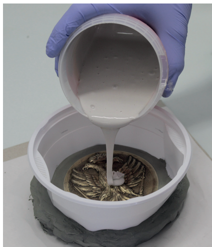
8. A plasztinbe ágyazott fedél leöntése szilikonnal
