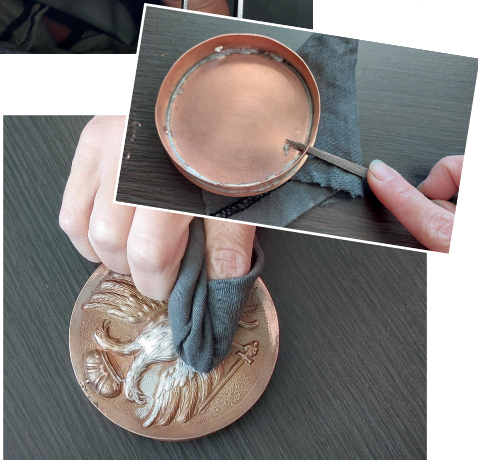
12–14. Az elkészült másolat körbefűrészelése, reszelése, festése
