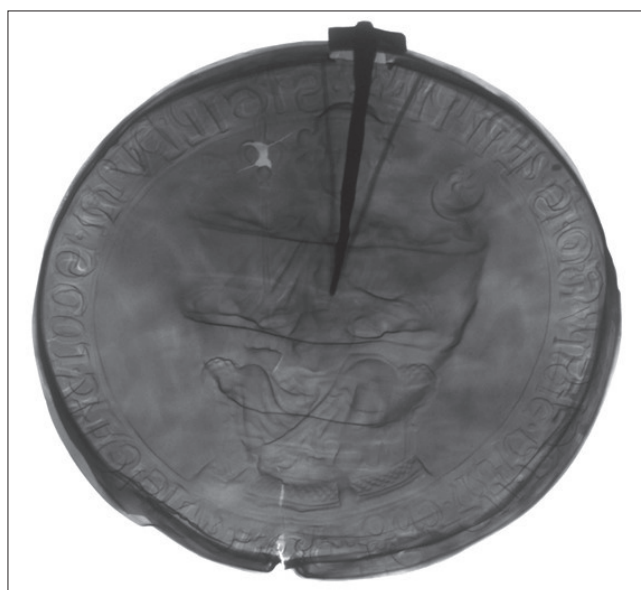
12. kép – Az aranybulla keresztmetszeti CT felvétele
