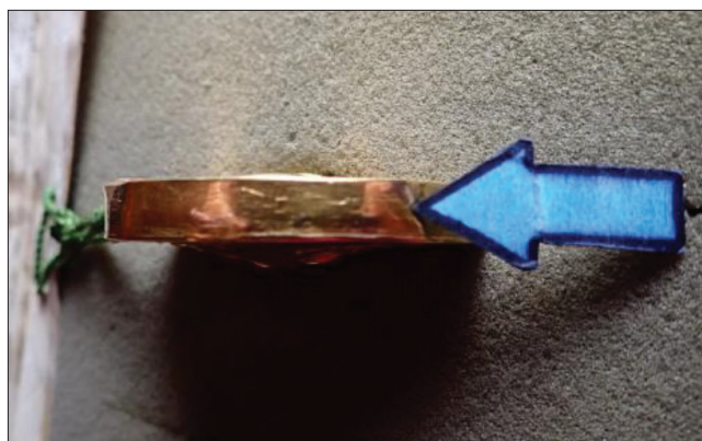
33. kép – Az „oldal alapfém 1” anyagvizsgálati hely
