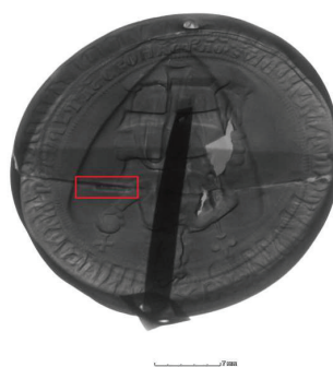
32. kép – A pecsét röntgen képe – Kereszt irányban egy merevítőt építettek be, amelyet a detektált lunkrek alapján forrasztással rögzítettek a pecsét egyik oldalához. Ezzel merőleges irányban egy zárólemez illeszkedik a pecséthez.
