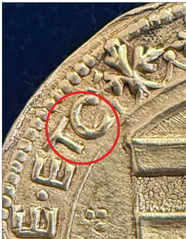
64. kép – Öntési hiba (buborék) a hátoldal köriratának betűjén
