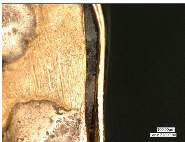
26. képsorozat – Viasz nyoma a zsinór kivezető nyílásánál, a zsinór fűzéséhez használt egyik lyuk belsejében és a palástlemez mellett
