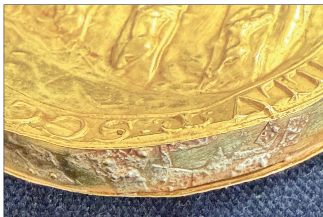
29. kép – Forraszanyag a paláston
