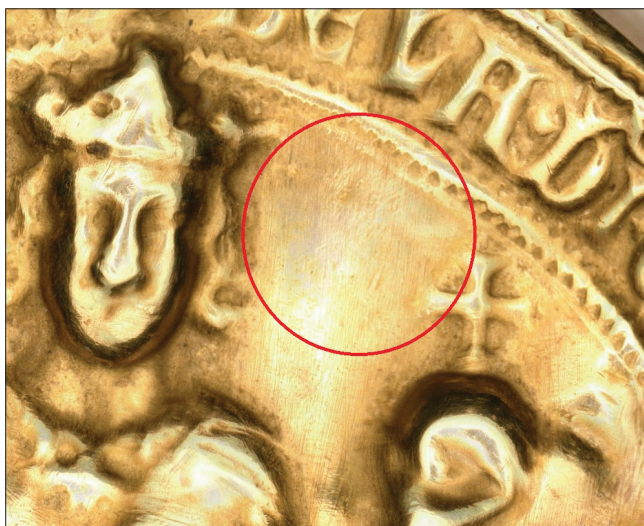
34. kép – A kalapálással történő megmunkálásra utaló szerszámanyomok
