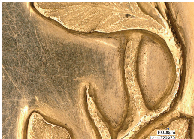
75. kép – A kiegészítő aranyozás nyomai
