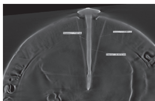
9. kép – CT metszeti kép – A rögzítőszeg geometriai jellemzői (hossza ~31 mm, axiális vastagsága 1,7 mm)
