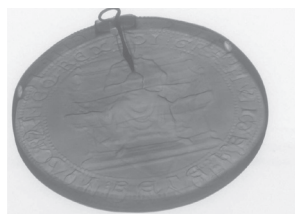
1. kép – Az alkotó nem használt merevítést a pecsétnél. Az illesztőszegnek kialakított furat mellett további két furat helyezkedik el a palástfelületen.
