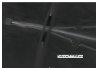
18. kép – A pecsét CT metszeti képe. A „rugós lemez két szárán, egymással szemben egy-egy közel 3 mm furatot alakítottak ki.
