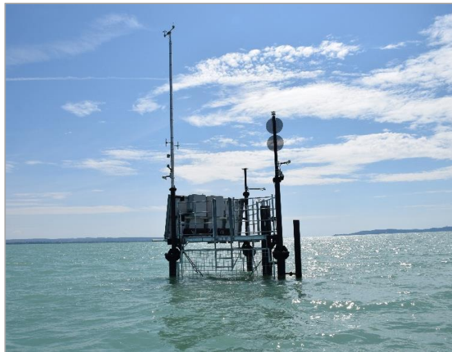
2. kép. Szigetüzemű hidrometeorológiai és vízminőségi kutatóállomás a Balatonon (Fotó: KDTVIZIG) Image 2. Island-operated hydrometeorological and water quality research station on Lake Balaton (Photo: KDTVIZIG)
