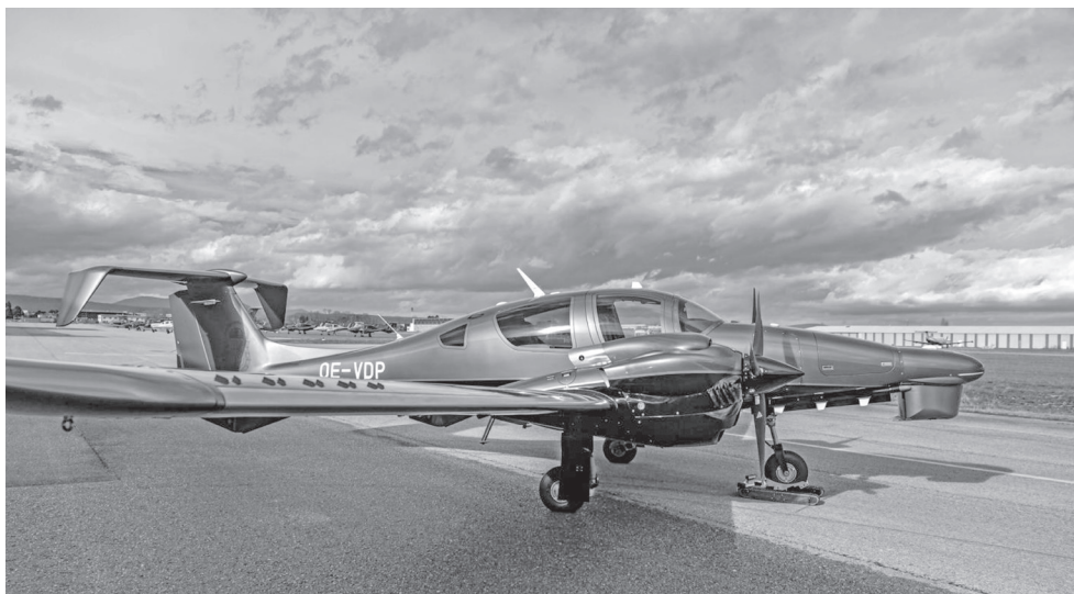
2. kép A Diamond DA62 MPP „SurveyStar” típust speciálisan légi távérzékelési feladatokra fejlesztették ki
