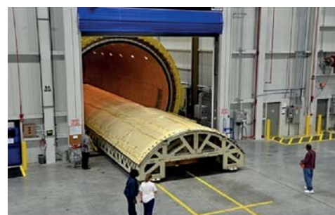
15. ábra. Prepregből történő kompozitalkatrész gyártásának elve
