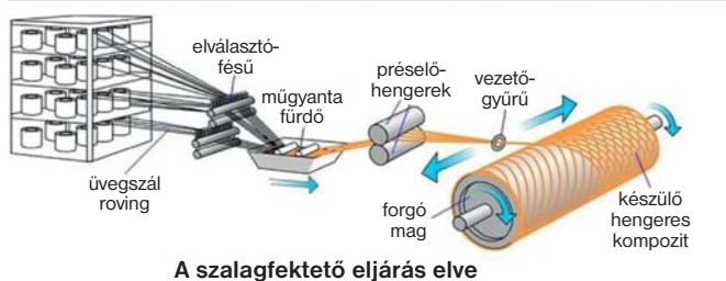
13. ábra. Kompozitalapú profilanyagok, hengeres és más alakú forgástestek előállítás
