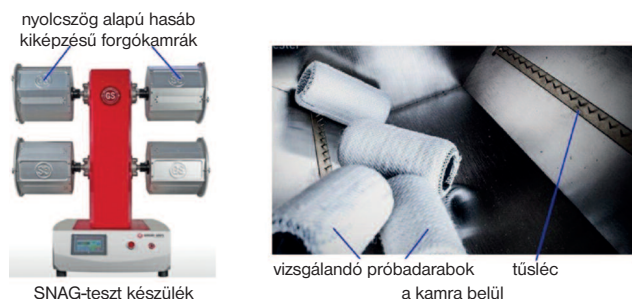
4. ábra. A száلكihúzóási hajlam forgókamrás vizsgálata
