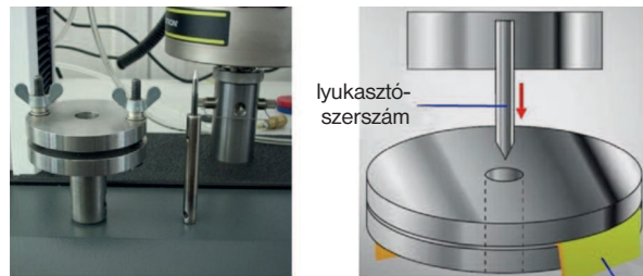
a két tárcsa közé behelyezett próbadarab
