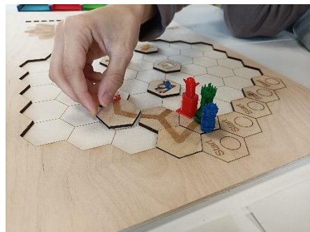
2. ábra Az El Mirador társasjáték 3D nyomtatott figurái és lézervágott játéktáblája
