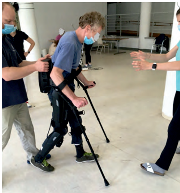
4. ábra: Járás a ReWalk 6.0 exoskeletonnal
