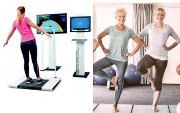
1. ábra: A vizsgálati személy stabilometriai paramétereinek vizsgálata stabilométer platform alkalmazásával – Fysiomed CS ALFA – stabilometric platform (bal oldali kép) (8); a vizsgálati személyek egy módosított flamingó tesztet végeznek (jobb oldali kép) (9).
