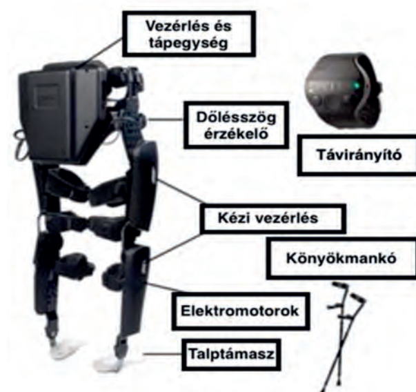
1. ábra: ReWalk 6.0 alsó végtagi exoskeleton
