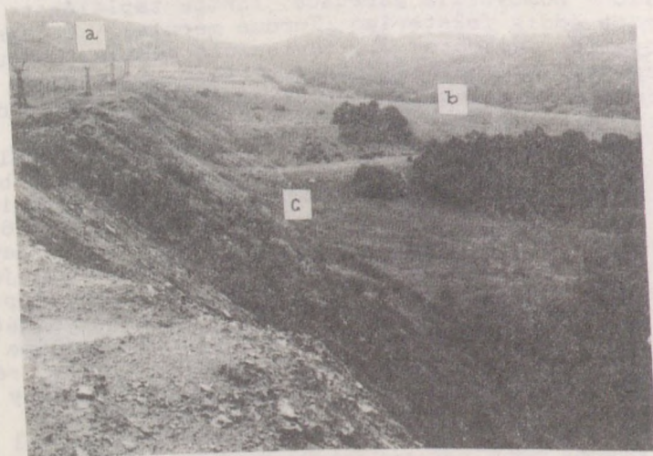
6. ábra: A Budafai-völgy III-as akna előterében: a = III-as akna; b = juhlegelő; c = kőgörgeteges meddőhányótalp, lejtéssel a Baranya-csatorna irányába /DNY/.
