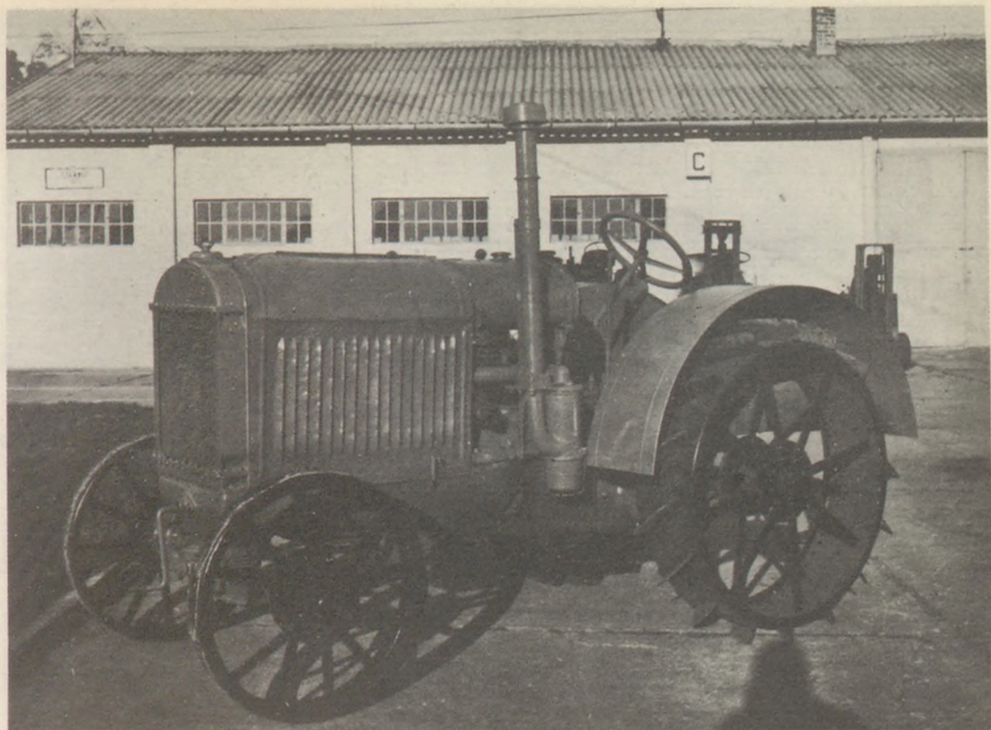
Mc. CORMICK – 20 Traktor Készült az IHC- traktorgyárban (USA) 1922-ben Teljesítménye: 20 LE
