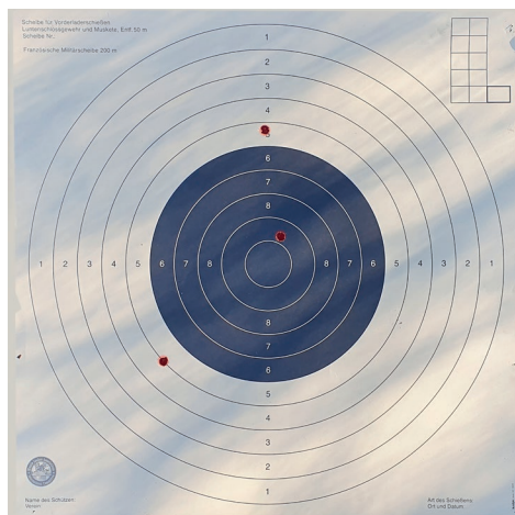
8. kép: Muskéta lövéseinek szórásképe 80 m-en feltámasztásból
