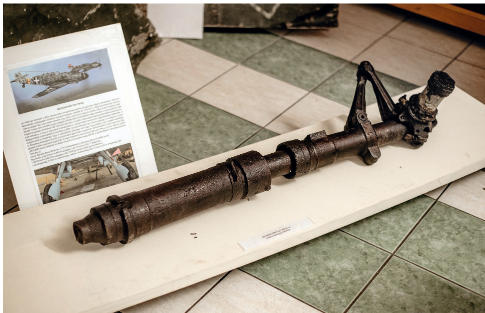
2. kép: Az Iharkút mellett lezuhant német Me-109G vadászepülőgép futószára Pálffy Sándor gyűjteményéből. (Fotó: Cseh Edina)
