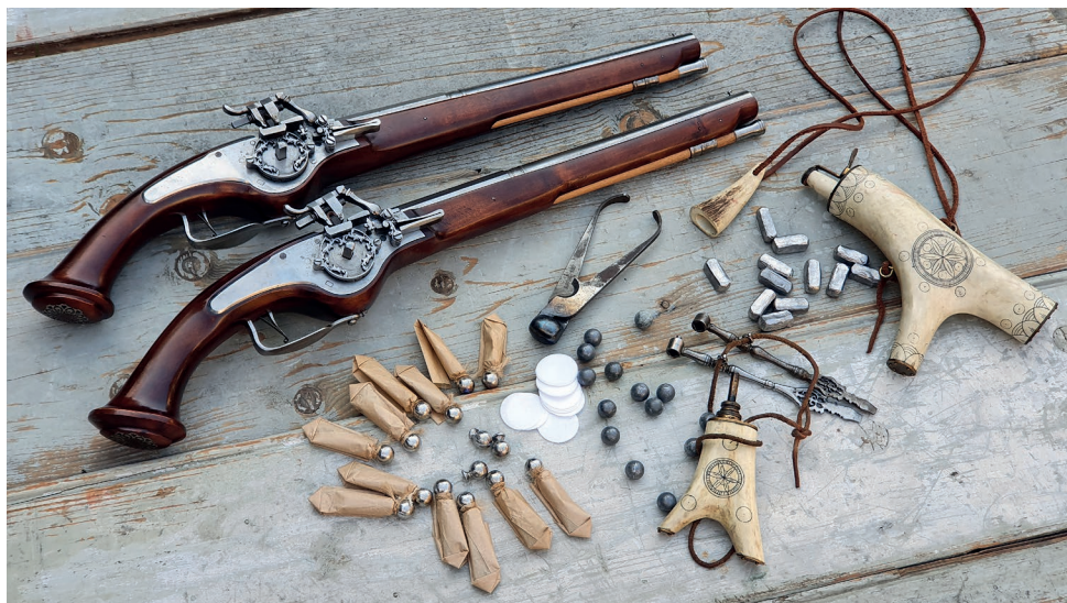
13. kép: Lőkísérletekre előkészített keréklakatos pisztolyok és töltényeik
