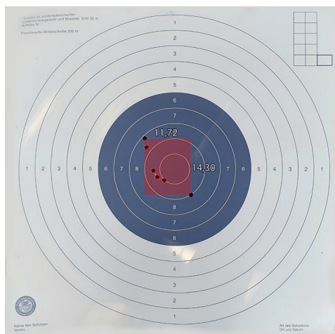
14. kép: A keréklakatos pisztoly szórásképe 10 m-en gömblövedékkel
