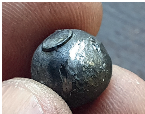
18. kép: A cső koptatásának nyomai a pisztolygolyón
