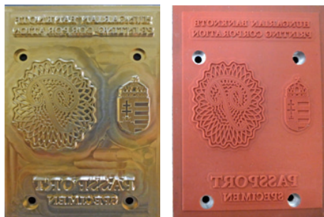
1. ábra Nyomóforma a) réz, b) szilikon
