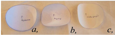
7. ábra Szál- és keresztirány meghatározás a, nyomtatott b, rajzlap c, művészpapír
