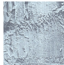
3. ábra Nyomóerő miatti rost diszlokáció
