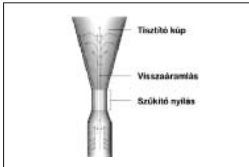
2. ábra. A besűrűsödött szennyezett szuszpenzió visszaáramlása az örvény közepében
