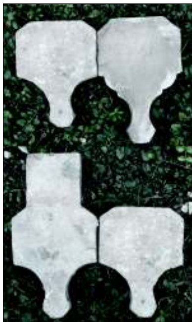
■ 5. kép: Idomtéglatípusok. © UTILITAS ■ Photo 5. Types of shaped bricks. © UTILITAS
