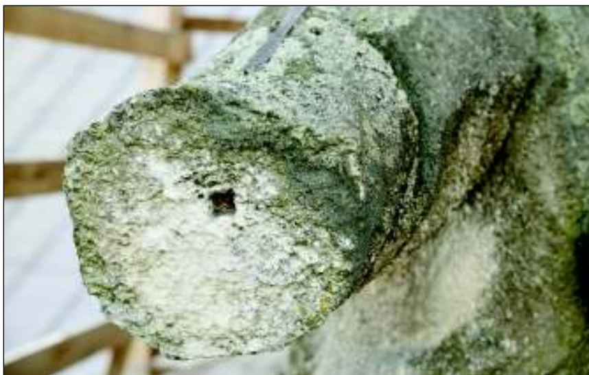
■ Foto 11. Antebraț detașat; în planul îmbinării apare urma ancorei ■ Photo 11. Damaged upper arm; the trace of the metal rod
