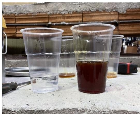
**Fig.1.** The „A” and „B” components of 3P resin.
