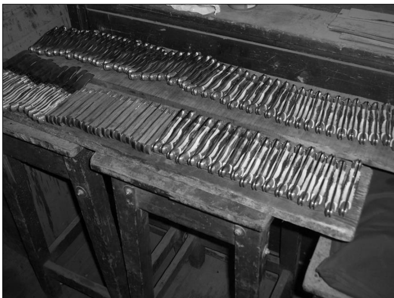
2. kép: Félkész bicskák sorakoznak a Révész Késes Műhelyben
