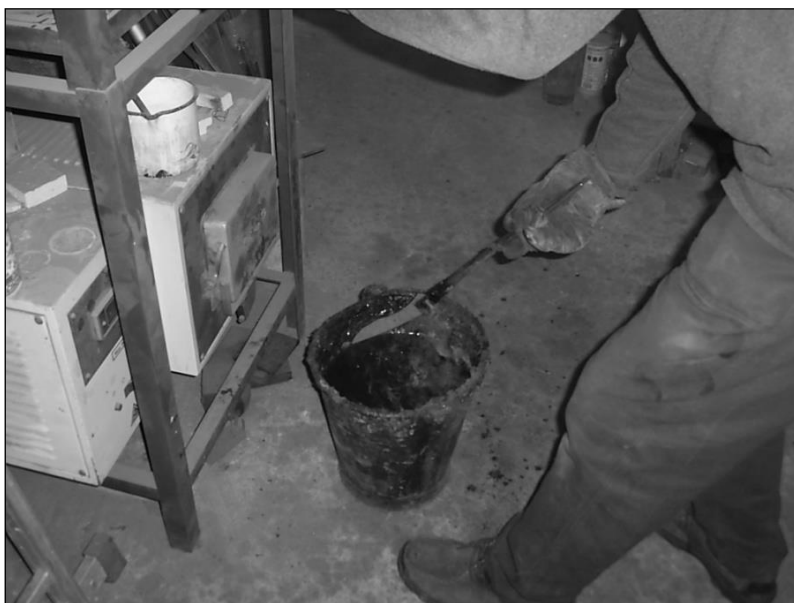
11. kép: Kocsis Ferenc pengét edz, olajban
