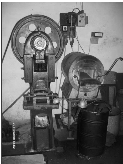
6. kép: Présgép és edzőkemence Tarjányi József műhelyében
