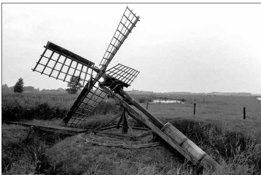
■ 23. kép. Hordozható vízáttemelő „malom”, Tacozijs (Hollandia) © SEBESTYÉN József ■ Photo 23. Portable water pump “mill”, Tacozijs (the Netherlands) © József SEBESTYÉN
