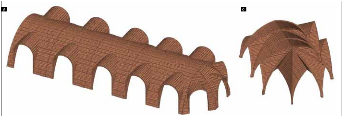
■ Figura 4. Axonometrie a) bolta barocă (zonă navă și cor) versus b) bolta gotică (zonă cor) © Tekla ILONCZAY-KRUK ■ Figure 4. Axonometry a) Baroque vault (nave and choir) versus b) Gothic vault (choir) © Tekla ILONCZAY-KRUK
