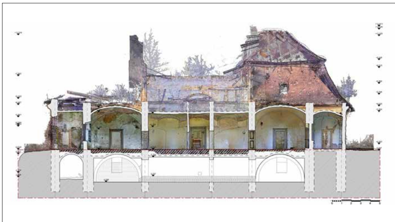
■ Fig. 4. Secțiune longitudinală și ortofoto (2020)
