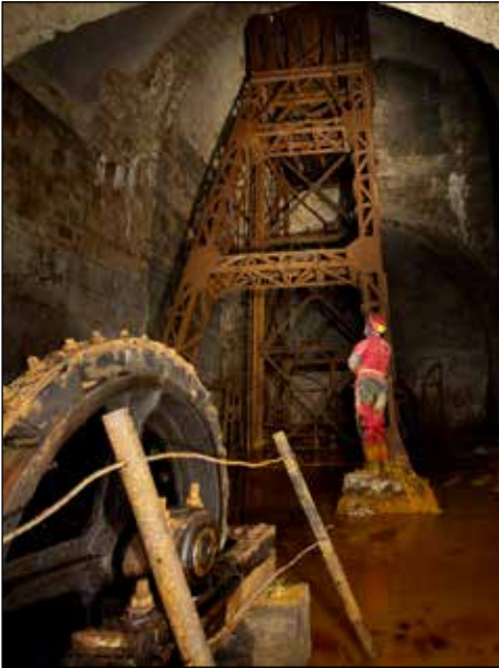
■ Foto 2. Trolitul de extracție acționat electric la exploatarea minieră la „Puțul Țarina” din Roșia Montană © Ivan ROUS, 2010
