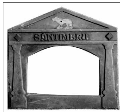
■ Foto 10. Matrița pentru luminatoare de lut („tabachere”) cu marca „Leul” al fabricii de cărămizi din Sântimbru © Volker WOLLMANN, 1985 ■ Photo 10. Mould for clay skylights with the brand “Leul” of the Brick Factory in Sântimbru © Volker WOLLMANN, 1985
