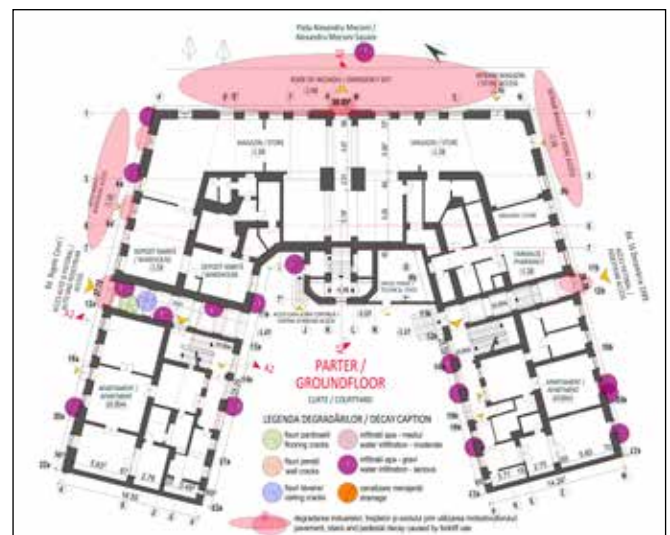
■ Fig. 2. Relevul parterului cu degradări ■ Figure 2. Ground floor survey showing decays
