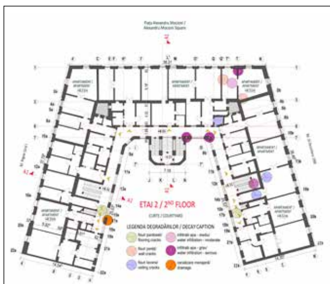
■ Fig. 4. Relevu etajului al doilea cu degradări ■ Figure 4. Second floor survey showing decays
