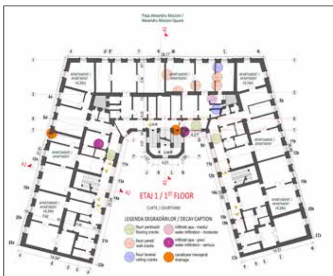
■ Fig. 3. Relevu etajului întâi cu degradări ■ Figure 3. First floor survey showing decays
