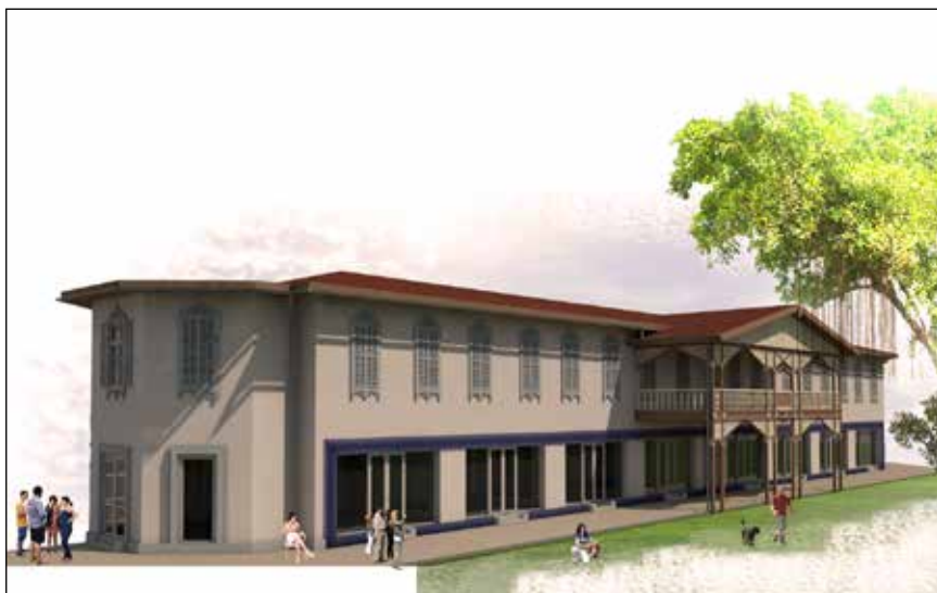
■ Fig. 6. Simulare foto fațadă principală spre parc – prezentare fără colonadă pentru explicarea golurilor propuse la parter © bondstudio 2018
