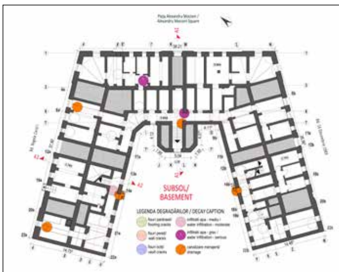
■ Fig. 1. Relevul subsolului cu degradări ■ Figure 1. Basement survey showing decays
