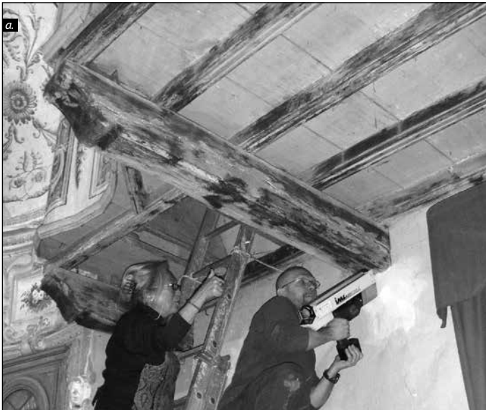
■ Figure 2. a) On-site inspections with resistance-drilling © Tanja MARZI; b) example of Resistograph® diagram ■ Fig. 2. a) Inspecții la fața locului cu foraj de rezistență © Tanja MARZI; b) exemplu de diagramă Resistograph®
