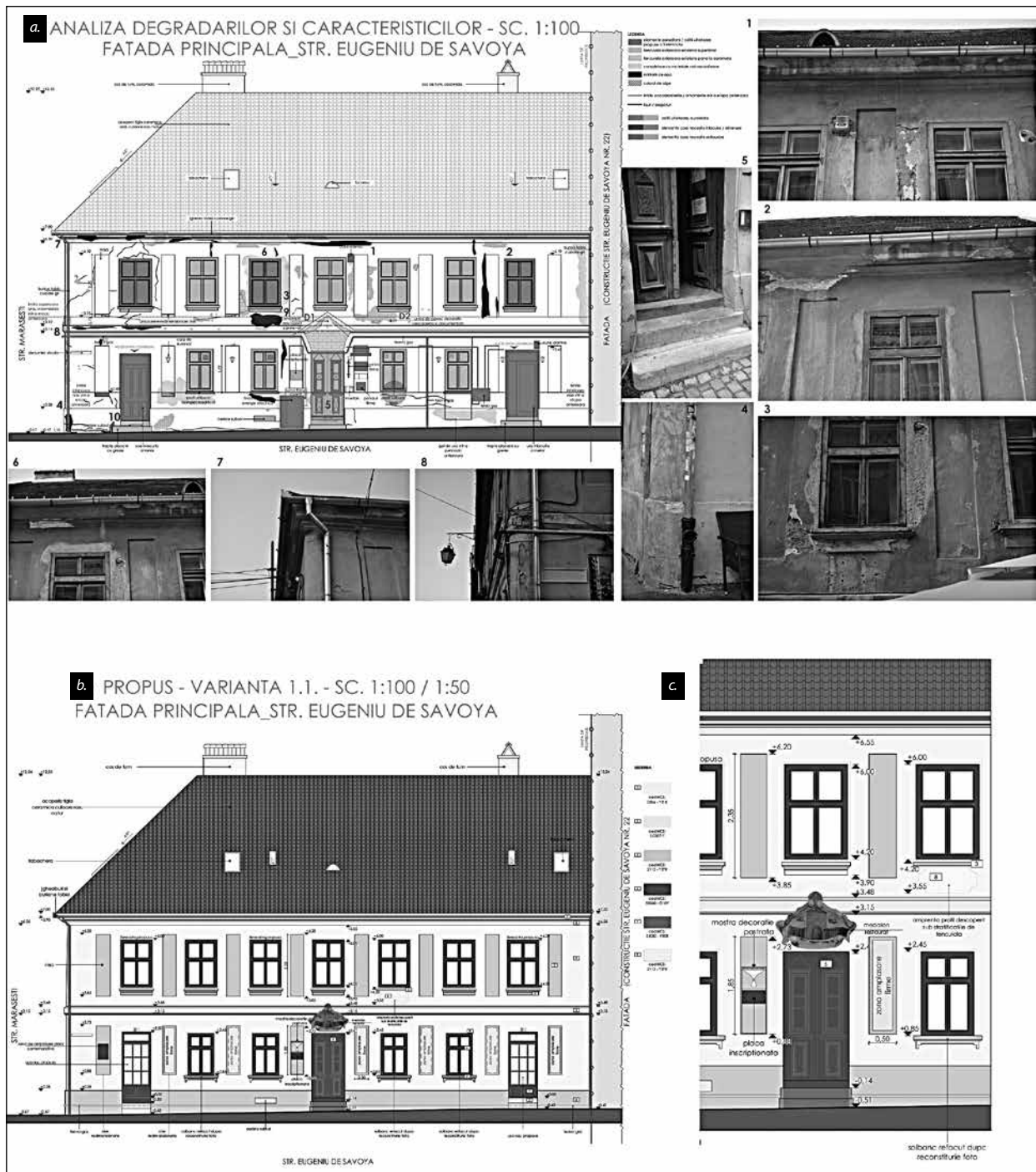
■ Fig. 7. Fațadă principală: a) degradări, b) propunere, c) detalii (PESCAR, DRAȘCOVICI & ROȘIU 2017) ■ Figure 7. Main elevation: a) degradations, b) proposal, c) details (PESCAR, DRAȘCOVICI & ROȘIU 2017)
