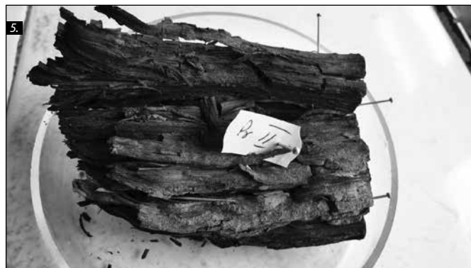
■ Foto 4-5. Dulap situat la suprafața șenalului cu degradare avansată, cu exces de umiditate (in situ) și după uscare (conținutul maxim de umiditate: 375%)
