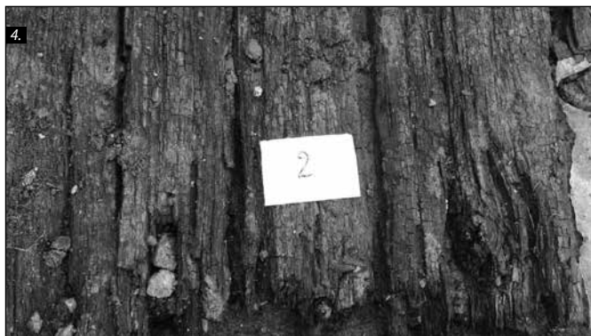
■ Foto 4-5. Dulap situat la suprafața șenalului cu degradare avansată, cu exces de umiditate (in situ) și după uscare (conținutul maxim de umiditate: 375%)
